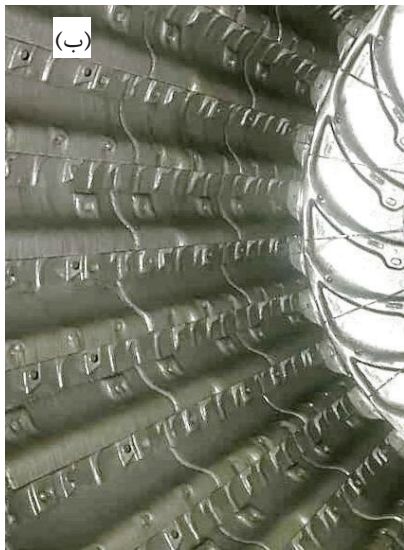
شکل ۱- نمای کلی آسیا؛ (الف) طراحی قدیم و (ب) طراحی جدید آستر.
