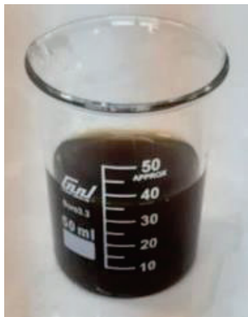
شکل ۱-۲ اکسید گرافن سنتز شده به روش هامرز بهبود یافته
