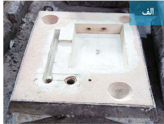
شکل ۲- (الف) تصویر تای زیر قالب و سیستم راهگاهی طراحی U شکل (ب) قطعه ریخته شده پس از تخلیه قالب
