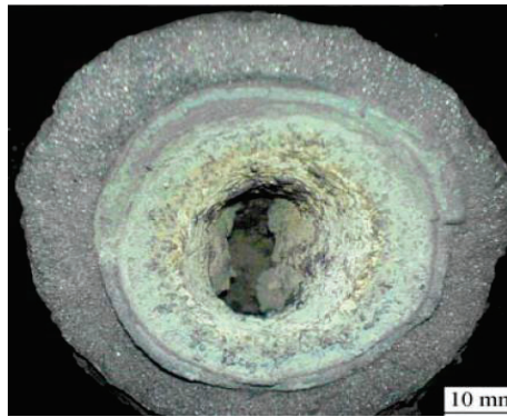
شکل ۱- تصویر کاهش قطر نازل در اثر گرفتگی آن.
