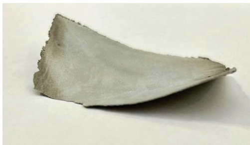
شکل ۲-۳. تصویر جدا شدن رسوب کادمیوم به صورت ورقه‌ای از کاتد.
