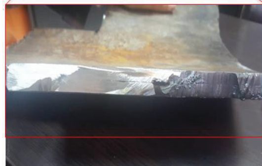
شکل ۵) الف) لوله در محل، ب) لوله برش خورده و عیب جدالایگی و HIC در مرکز قطعه، ج) نحوه برش لوله جهت نمونه سازی.
