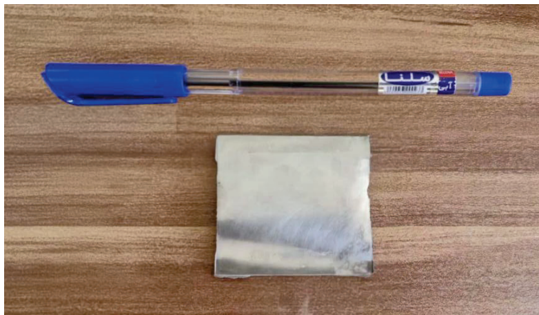
شکل ۳- ورق کبات بدست آمده در دمای ۶۰ درجه سانتی‌گراد تحت الکتروپینینگ پالس معکوس.
