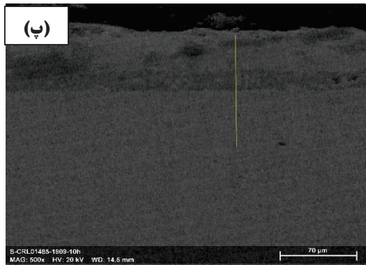
شکل ۸- آنالیز اسکن خطی از سطح نمونه پوشش داده شده در مخلوط پودر فروکروم و فرووانادیم در دمای ۱۰۰۰°C و زمان‌های: الف) ۷ ساعت، ب) ۹ ساعت و پ) ۱۱ ساعت.
