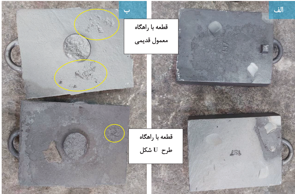
شکل ۴- تصاویر قطعات در شرایط as cast بعد از شات بلاست (الف) کف قطعات (ب) روی قطعات. محل عیوب سرباره روی سطح با خط زرد مشخص شده است.
