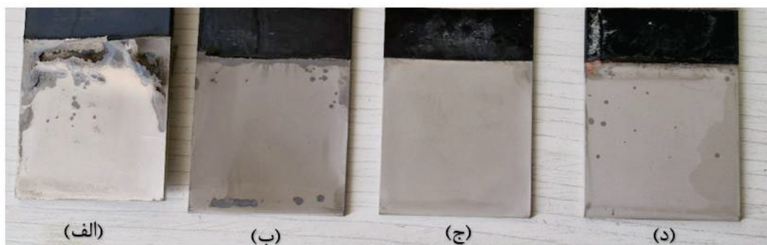
شکل ۲- تصاویر رسوب کبالت حاصل از الکتروپلینگ در دماهای مختلف: (الف) ۲۵ C°، (ب) ۴۰ C°، (ج) ۶۰ C°، (د) ۸۰ C°.
