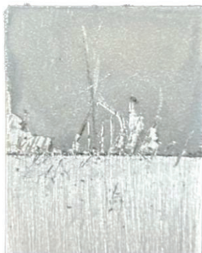
شکل ۳-۳. تصویر رسوب کادمیوم با چسبندگی بالا به کاتد.
