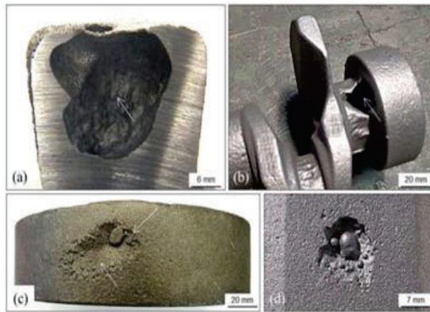
شکل ۳. عیوب انقباض اولیه موجود در (a) تغذیه چدن خاکستری، (b) میل لنگ از جنس چدن داکتیل که بدون افزودن ماده جوانه‌زا ریخته‌گری شده است (انبساط گرافیت کم)، (c, d) دو قطعه ریخته‌گری شده از جنس چدن خاکستری با انقباض دیواره به عنوان فرورفتگی‌های حاوی قطرات فسفید [۱]
