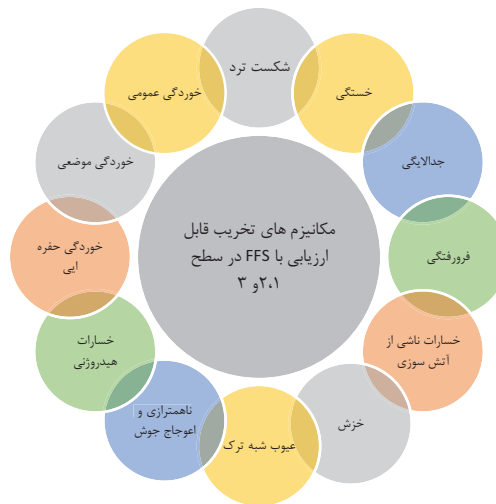
(شکل ۱) عیوب و مکانیزم‌های تخریب قابل ارزیابی با FFS [۱].
