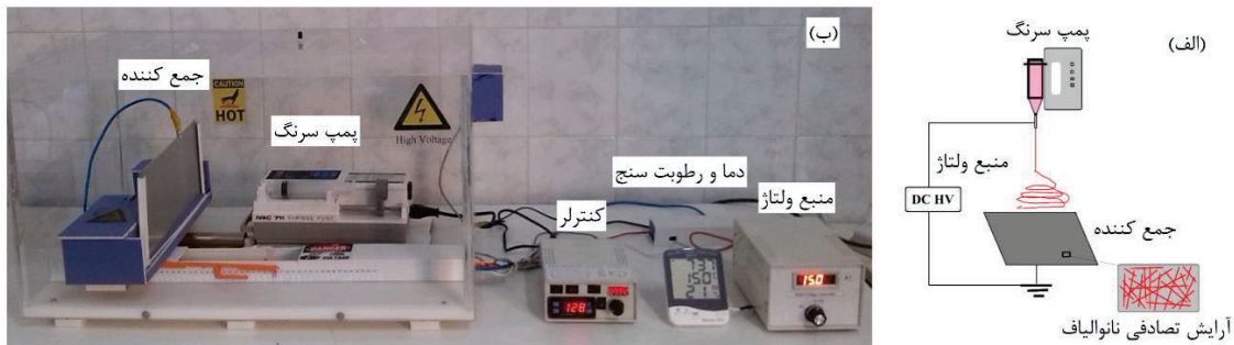
شکل ۱- (الف) طرحواره فرایند الکترورسی و (ب) بخش‌های مختلف دستگاه الکترورسی مورد استفاده در این پژوهش.
