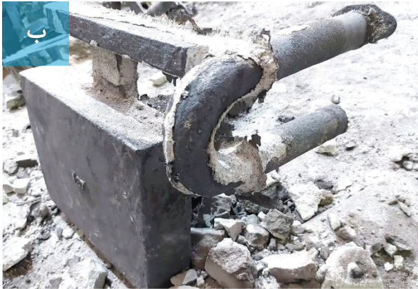
شکل ۲- (الف) تصویر تای زیر قالب و سیستم راهگاهی طراحی U شکل (ب) قطعه ریخته شده پس از تخلیه قالب
