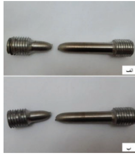
شکل ۱- تصاویر نمونه‌های کششی دو فولاد گرید ۱۱ و ۲۲ بعد از عملیات حرارتی به ترتیب در دمای ۶۵۰ و ۷۵۰ درجه سانتی‌گراد و پس از شکست.
