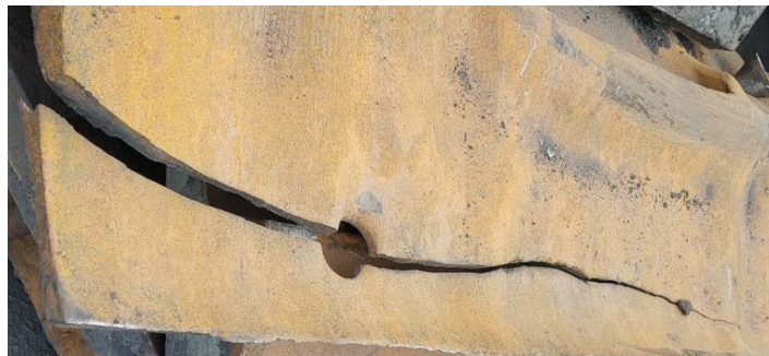
شکل ۸- تصویر آستر ترک خورده طرح قدیم.
