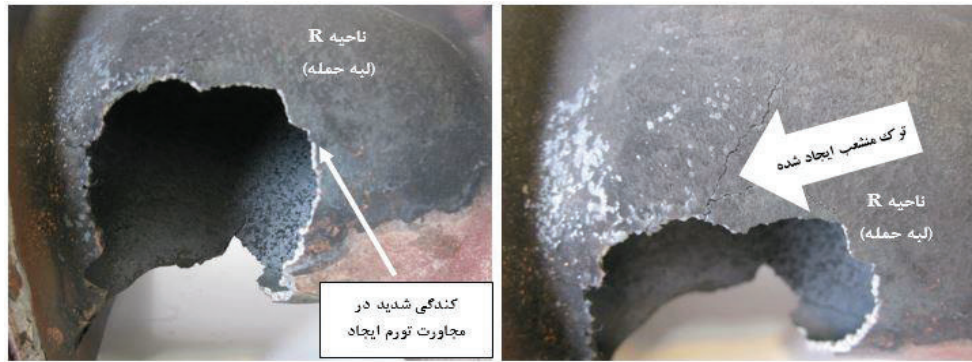
شکل ۱- ناحیه لبه حمله یا R که دچار تخریب‌های وسیعی شده است.
