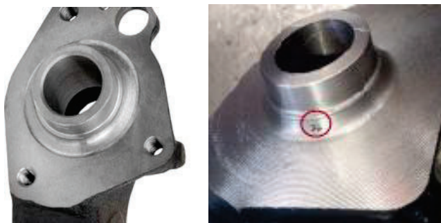
شکل ۱۹. سمت راست نمونه با 0.1%wt و سمت چپ نمونه با 0.17%wt جوانه زا.
